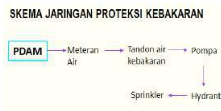
Gambar 4.12. Diagram Sistem Proteksi Kebakaran Sumber : Analisa Penulis
