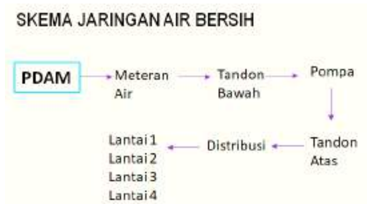
Gambar 4.11. Diagram Jaringan Air Bersih Sumber : Analisa Penulis
