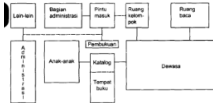
Gambar 2.11. Struktur dan bagan ruang perpustakaan secara umum
