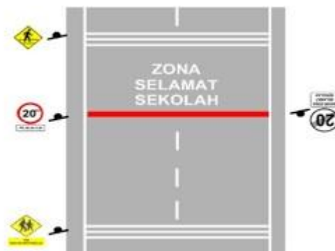
Gambar 2.3 Pemasangan pita penggaduh pada Zona Selamat Sekolah
