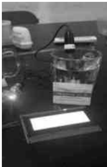
Gambar 4.10 Proses Kalibrasi Sensor pH (Sumber : Penulis)
