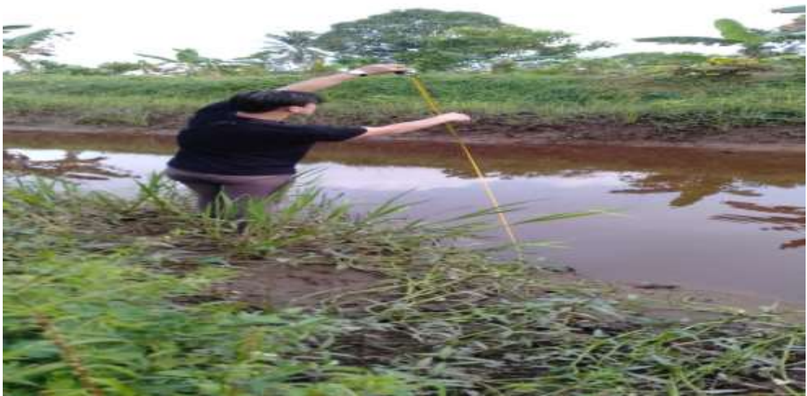
Lampran 3 mengukur dimensi saluran sekunder daerah irigasi Desa Gunung Putih
