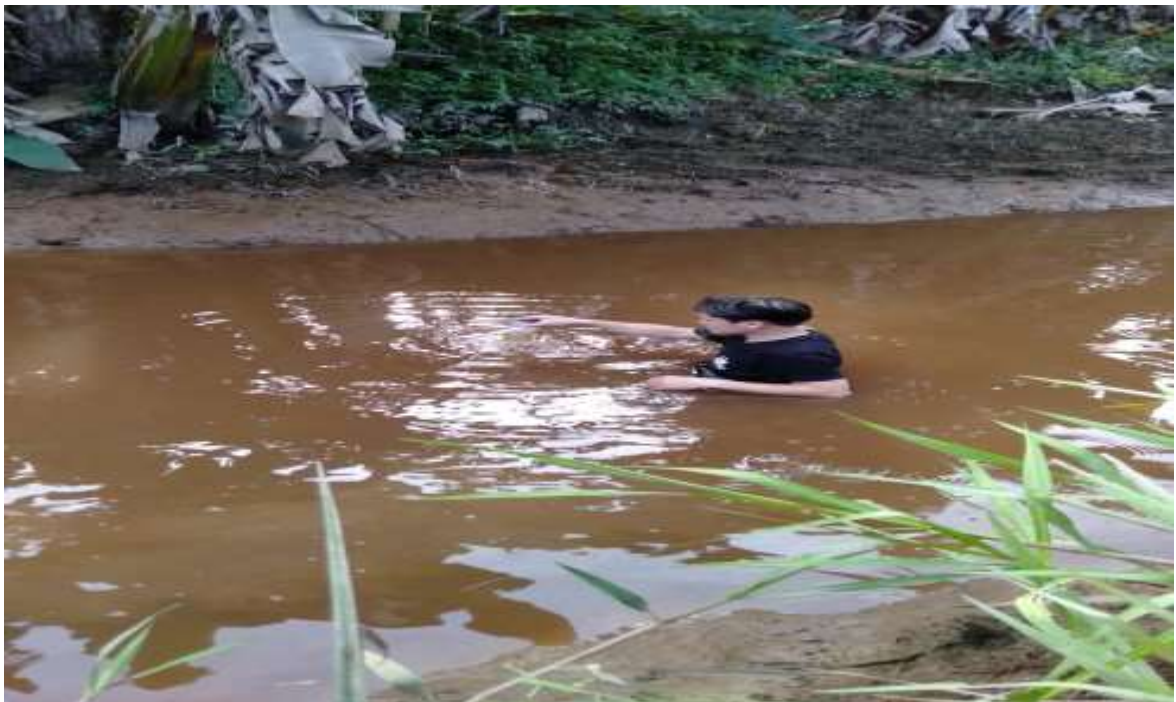
Lampran 4 mencari kecepatan aliran saluran sekunder daerah irigasi Desa Gunung Putih
