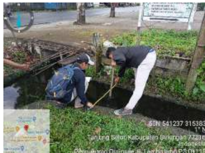
Pengukuran Dimensi Saluran STA 0+125 (Persimpangan Jeruk)
