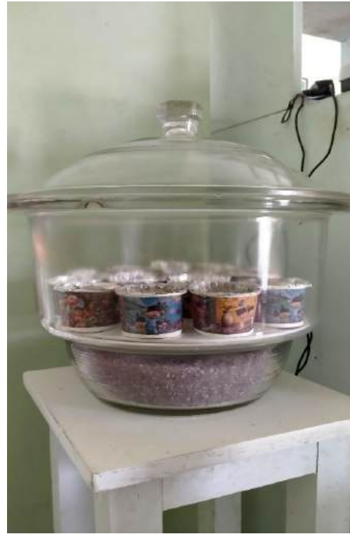
Proses Pendinginan Es Krim Nanas Madu Setelah Pengovenan, Menggunakan Desikator
