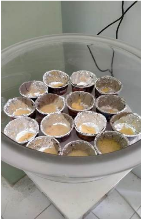
Proses Pendinginan Es Krim Nanas Madu Setelah Pengovenan, Menggunakan Desikator
