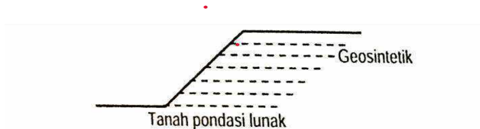
Gambar 2.6 Peletakan Geotekstil Untuk Memperkuat Lereng Timbunan
