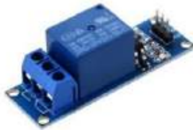
Gambar 2.4. Modul Relay (Sumber : www.arduinoindonesia.id )
