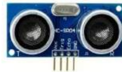
Gambar 2.1 Modul Sensor Ultrasonik (Sumber : www.arduinoindonesia.id )
