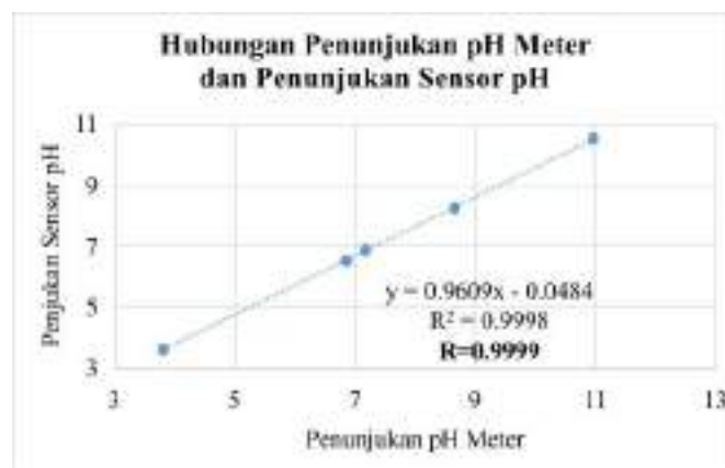
Gambar 4.6 Grafik Hubungan Penunjukan pH meter dan Penunjukan Sensor pH (sumber : penulis).
