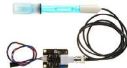
Gambar 2.6. Modul Sensor pH (Sumber : www.cncstorebandung )
