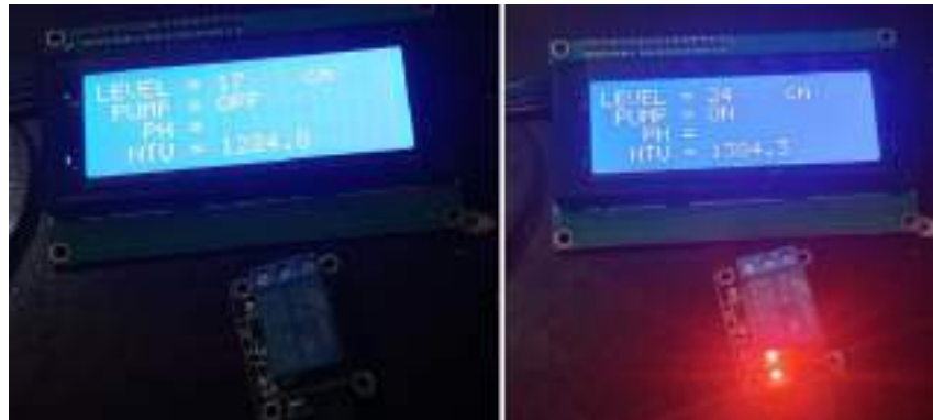
Gambar 4.11 Modul Relay. Kiri : Relay Mati. Kanan : Relay Aktif (Sumber : Penulis)
