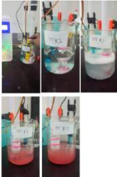
Gambar 4.7 Pengambilan Data pH dan Kekeruhan dari 5 Sampel Cairan (Sumber : Penulis)
