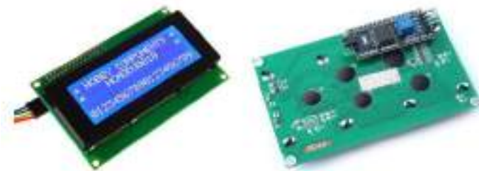
Gambar 2.3. Modul LCD I2C 20 x 4 (Sumber : www.arduinoindonesia.id )
