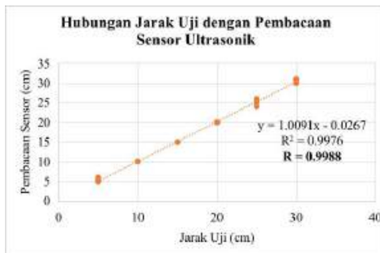
Gambar 4.4 Grafik Hubungan Jarak Uji dengan Pembacaan Sensor Ultrasonik (Sumber : Penulis)
