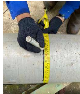
Gambar 2. Pengukuran Pipa untuk alat Double Ring Infiltrrometer Sumber : Dokumentasi Pribadi
