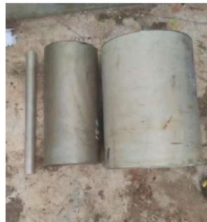
Gambar 4. Hasil Pemotongan Pipa 12" dan 8" Untuk alat Double Ring Infiltrrometer Sumber : Dokumentasi Pribadi
