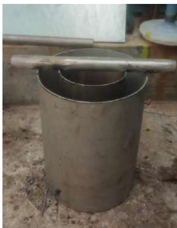
Gambar 5. Hasil Assembly alat Double Ring Infiltrrometer Sumber : Dokumentasi Pribadi
