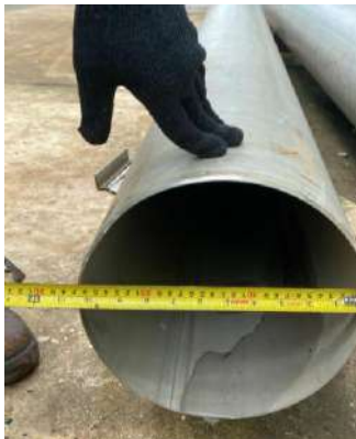
Gambar 3. Pemotongan Pipa Untuk alat Double Ring Infiltrrometer Sumber : Dokumentasi Pribadi
